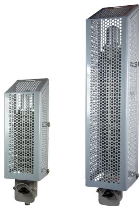
Das elektrische Schiffsheizgerät Typ HGL / MA - Marine-Ausführung - entspricht den technischen Anforderungen des deutschen Normblattes VG 88974. Das Heizgerät wird mit eingebautem Aus- bzw. Regelschalter geliefert. Die Heizgeräte sind serienmäßig mit einem automatisch auslösenden Temperaturbegrenzer ausgerüstet. Dieser kann nur mit Hilfe von Werkzeug wieder eingeschaltet werden.
