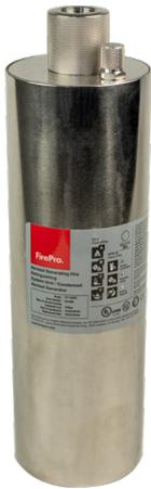
Der FP-500S ist ein Aerosol-Löschgenerator mit elektrischer oder thermischer (Thermalauslöser notwendig) Auslösung, welcher nach Auslösung ein Lösch-Aerosol freisetzt, was zur Brandbekämpfung bei Raum- oder Objektflutung dient.
