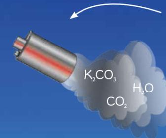
Ein Aerosol ist ein Gemisch aus einem Gas und feinsten flüssigen oder festen Partikeln. Beim Auslösen eines Aerosol-Löschgenerators wird das Aerosol auf Basis von Kaliumcarbonat erzeugt und freigesetzt.
