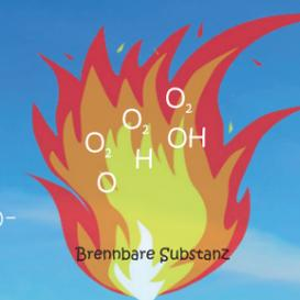
**Chemischer Prozess:** Wenn das Aerosol auf die Flamme trifft, wird durch die Bindung der freien Radikale die Kettenreaktion des Verbrennungsprozesses unterbrochen. Die Flamme erlischt.
